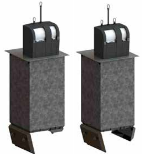
Elkocontaineren fås med 1, 2 eller 3 krogssystem. Her ses hvordan bundklapperne åbnes ved træk i krogene.
