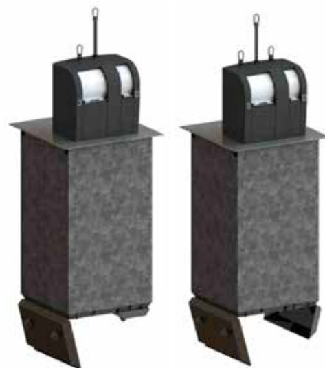
Elkocontaineren fås med 1, 2 eller 3 krogssystem. Her ses hvordan bundklapperne åbnes ved træk i krogene.
